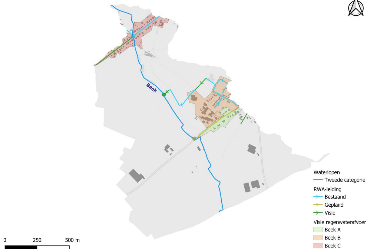
Figuur 7-28: RWA-leidingen en visie regenwaterafvoer van deelzone 2.
