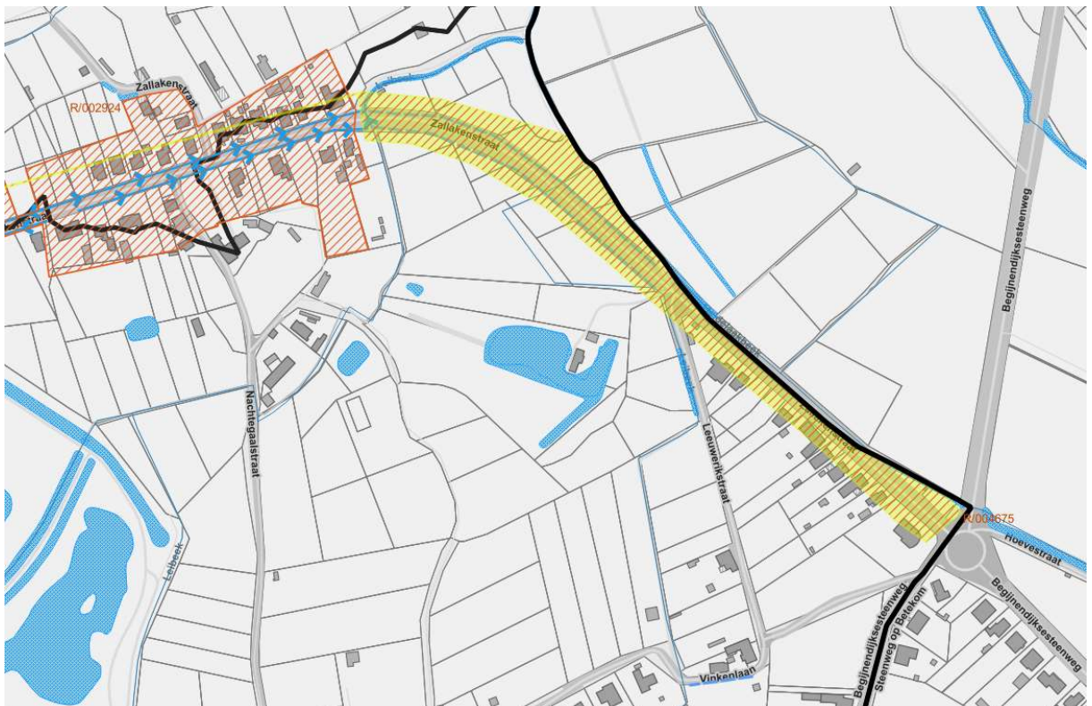
Figuur 159: Geplande RWA-riolering (blauwe pijlen) en buffering (paars) in Fluviusproject R/004675 in deelzone Heidelaakbeek (geel gemarkeerd)
