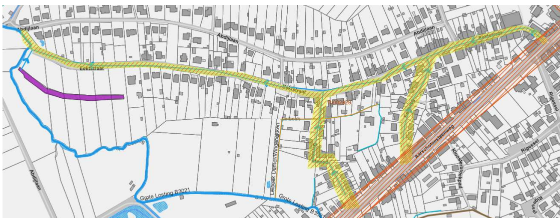
Figuur 109: Geplande RWA-riolering (blauwe pijlen) en buffering (paars) in Fluviusproject R/002929 (geel gemarkeerd)
