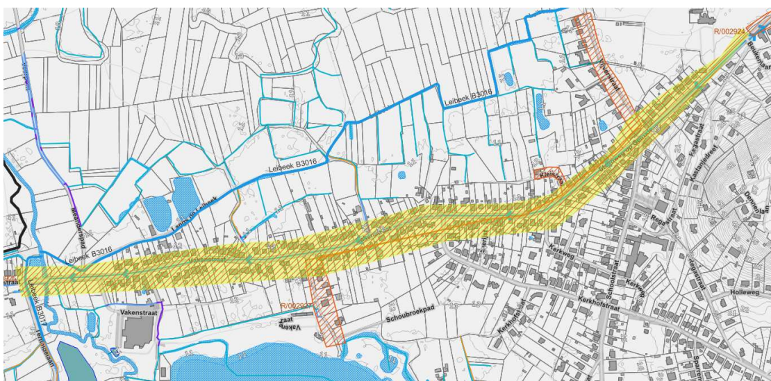
Figuur 115: Geplande RWA-riolering (blauwe pijlen) en buffering (paars) in Fluviusproject R/002925 (geel gemarkeerd)
