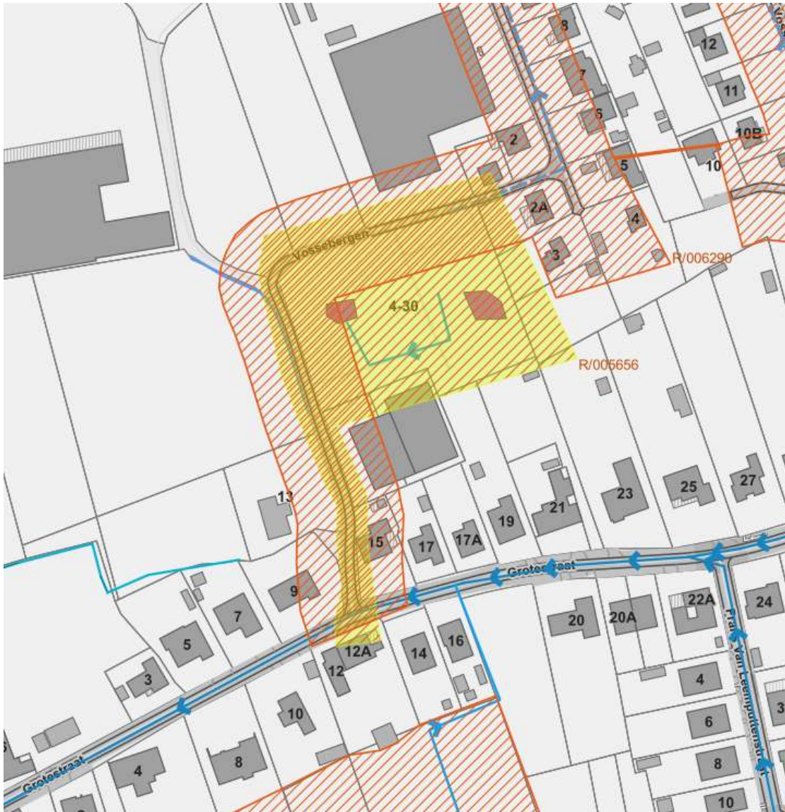
Figuur 185: Geplande RWA-riolering (blauwe pijlen), grachten (blauw gestreept) en infiltratieleidingen (blauw gestipt) in Fluviusproject R/005656 (geel gemarkeerd).
