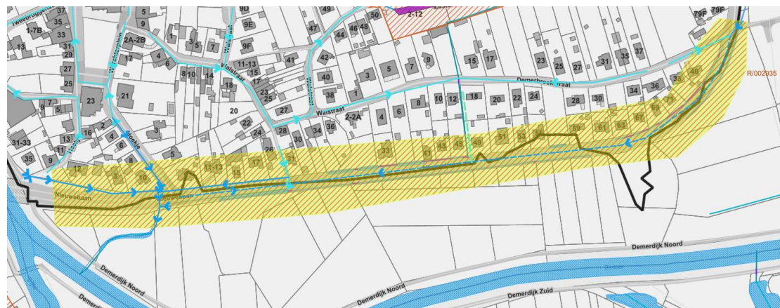
Figuur 188: Geplande RWA-riolering (blauwe pijlen), grachten (blauw gestreept) en infiltratieleidingen (blauw gestipt) in Fluviusproject R/002935 (geel gemarkeerd)
