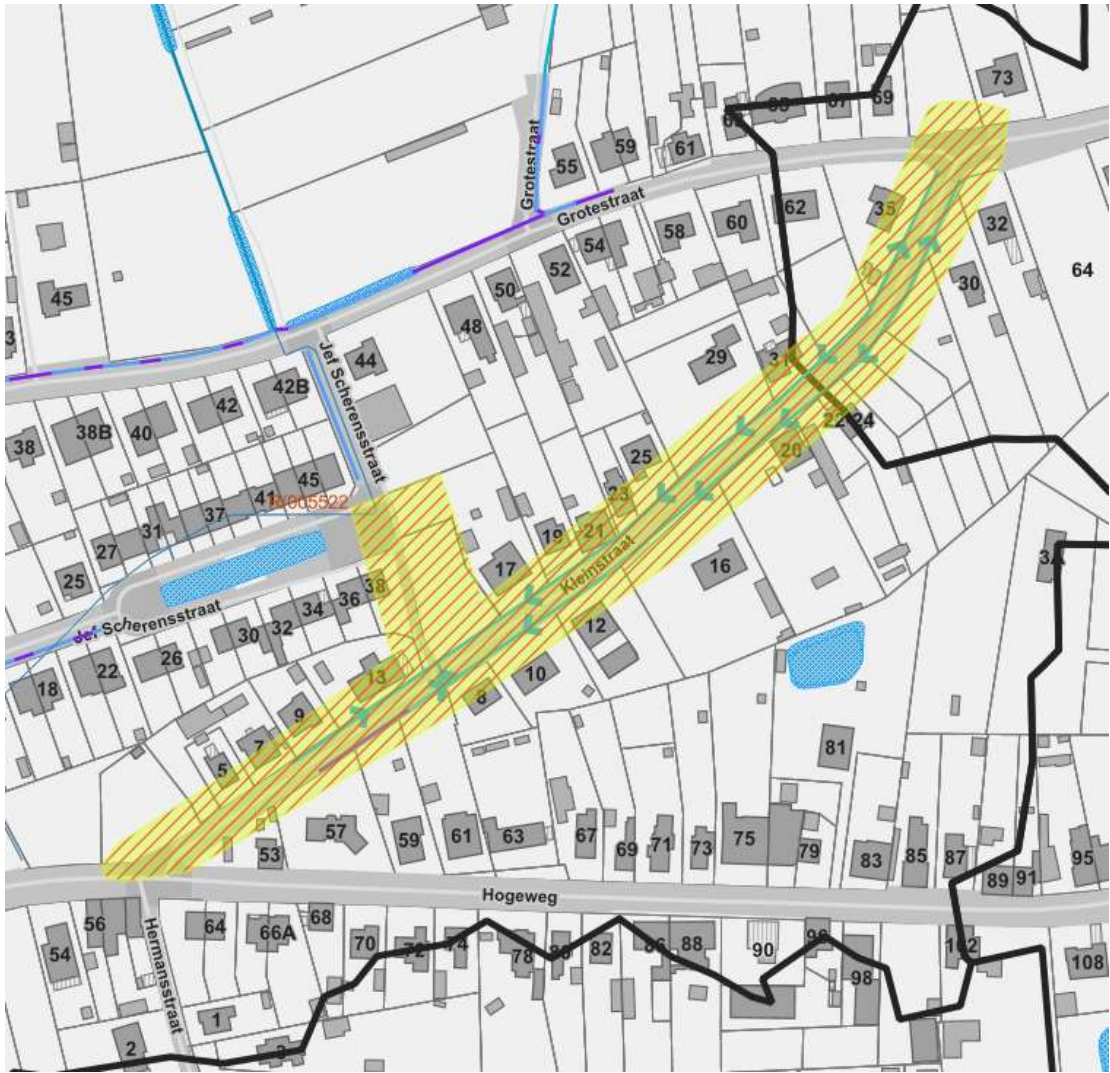
Figuur 183: Geplande RWA-riolering (blauwe pijlen), grachten (blauw gestreept) en infiltratieleidingen (blauw gestipt) in Fluviusproject R/005522 (geel gemarkeerd).
