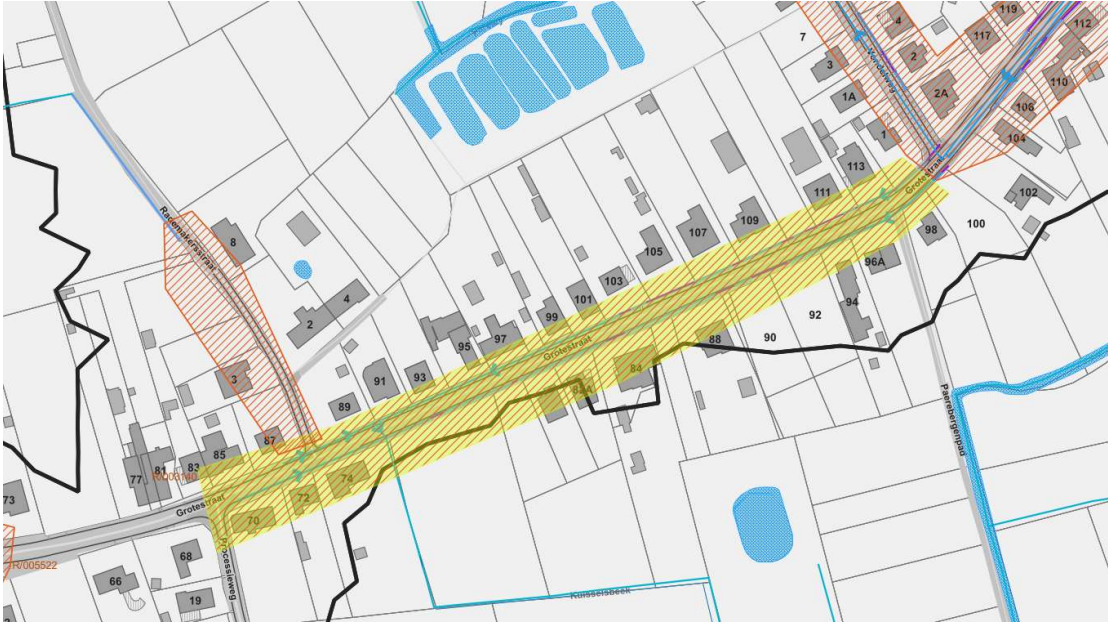
Figuur 182: Geplande RWA-riolering (blauwe pijlen), grachten (blauw gestreept) en infiltratieleidingen (blauw gestipt) in Fluviusproject R/003140 (geel gemarkeerd)
