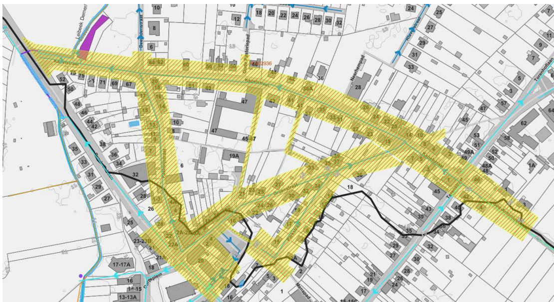
Figuur 114: Geplande RWA-riolering (blauwe pijlen) en buffering (paars) in Fluviusproject R/002936 (geel gemarkeerd)
