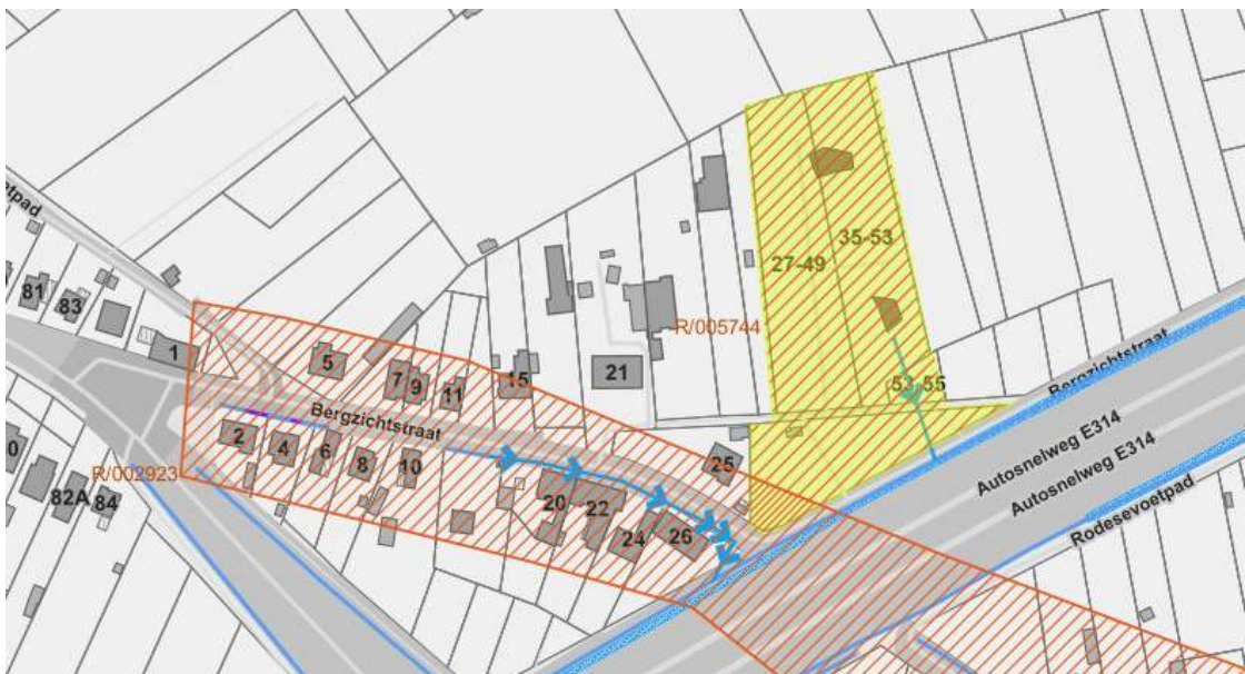
Figuur 105: Geplande RWA-riolering (blauwe pijlen) en buffering (paars) in Fluviusproject R/005744 (geel gemarkeerd)
