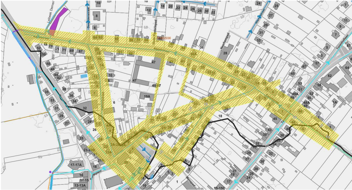
Figuur 206: Geplande RWA-riolering (blauwe pijlen) en buffering (paars) in Fluviusproject R/002936 (geel gemarkeerd)
