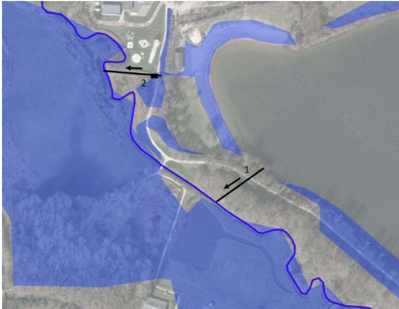
Figuur 148: Waargenomen overstroming ter hoogte van de Plas van Rotselaar tijdens extreem neerslag event in juli 2021 waarbij het water kon terugstromen naar de Winge via nummer 1. Een tweede verbinding t.h.v. nummer 2 staat ter discussie.
