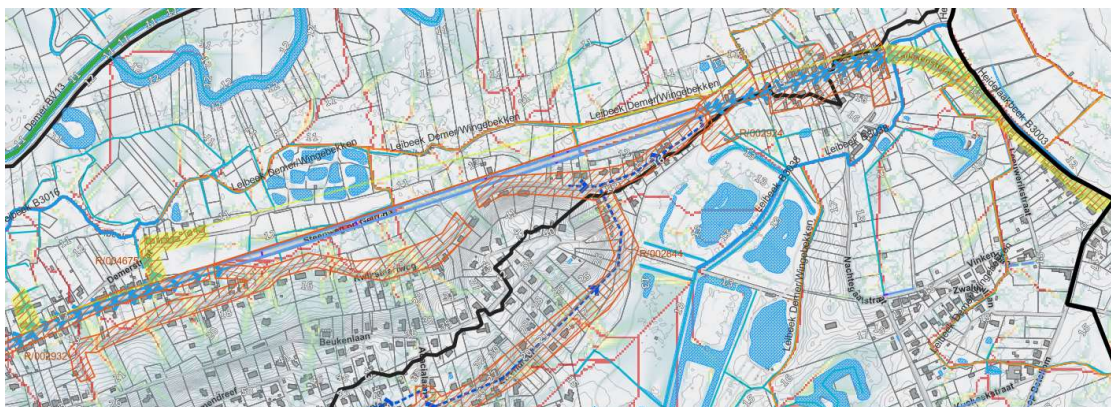
Figuur 118: Geplande RWA-riolering (blauwe pijlen) en buffering (paars) in Fluviusproject R/004675 (geel gemarkeerd)
