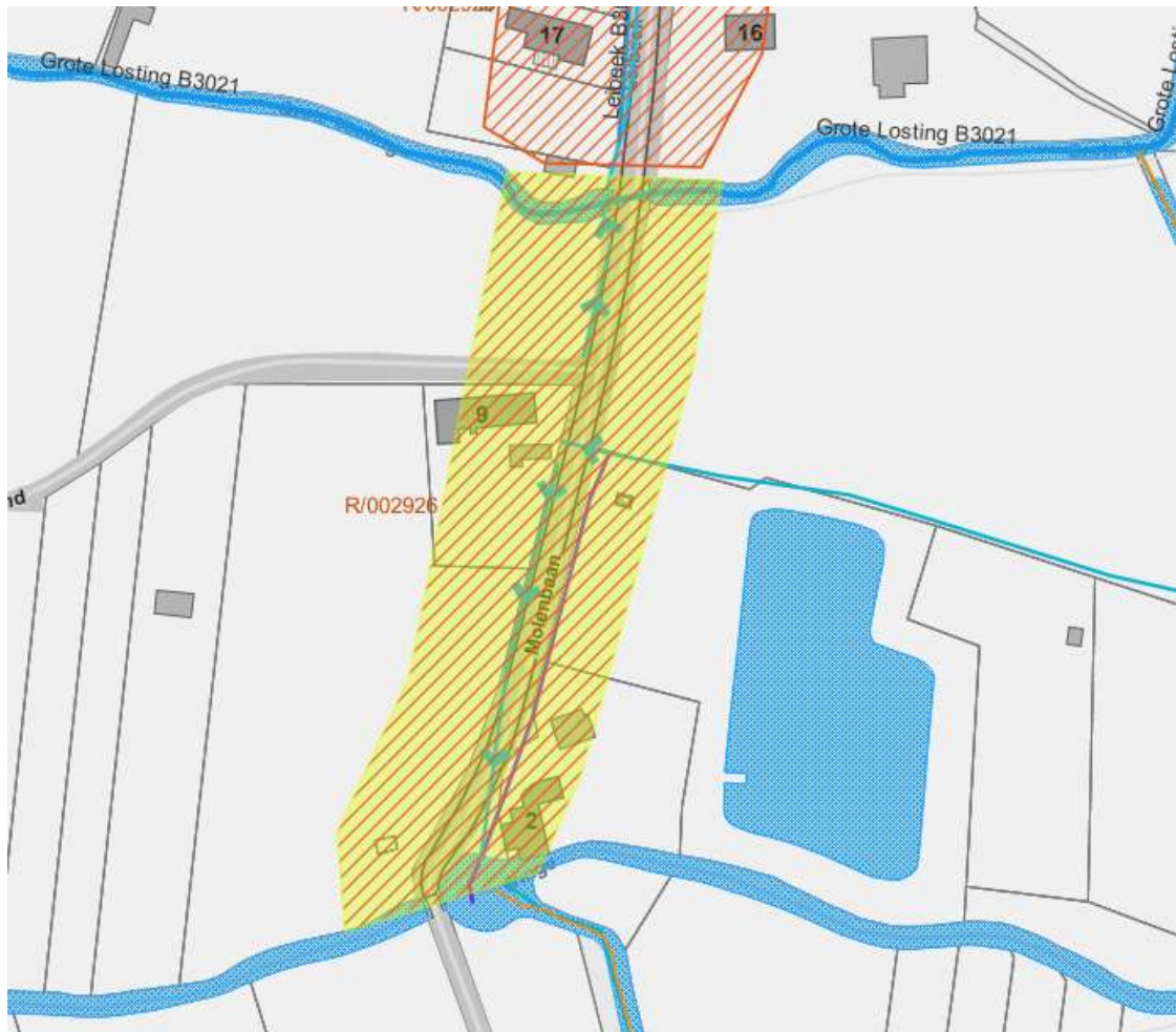
Figuur 103: Geplande RWA-riolering (blauwe pijlen) en buffering (paars) in Fluviusproject R/002926 (geel gemarkeerd)
