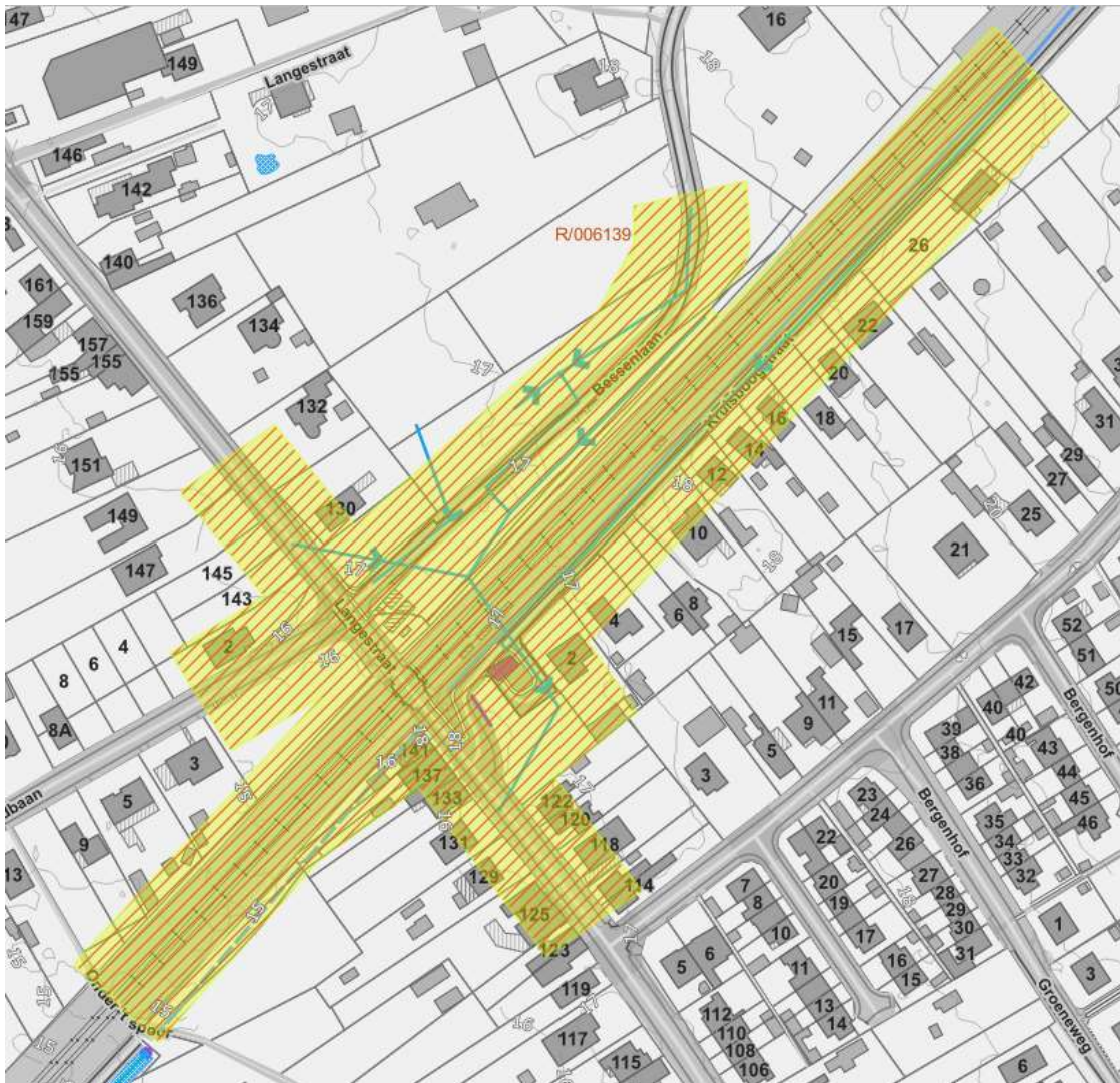
Figuur 110: Geplande RWA-riolering (blauwe pijlen) en buffering (paars) in Fluviusproject R/006139 (geel gemarkeerd)
