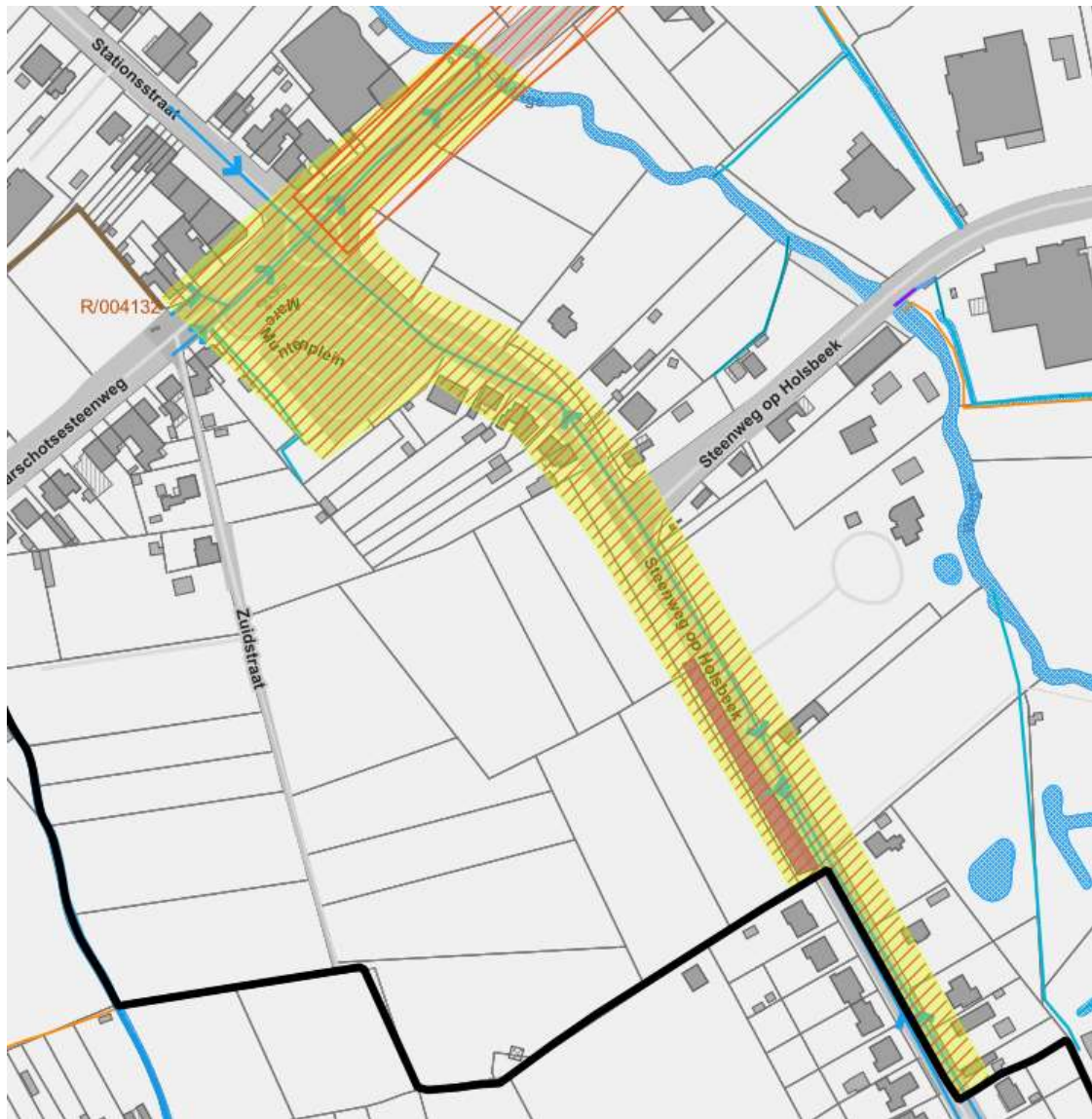
Figuur 107: Geplande RWA-riolering (blauwe pijlen) en buffering (paars) in Fluviusproject R/004132 (geel gemarkeerd)
