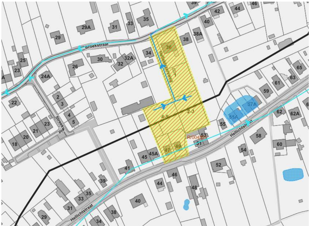
Figuur 166: Geplande RWA-riolering (blauwe pijlen) in Fluviusproject R/004521 (geel gemarkeerd)
