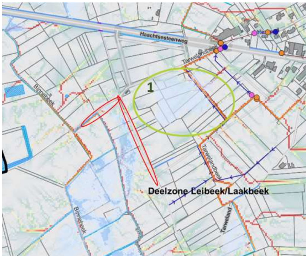
Figuur 214: Overzicht knelpunten met aanduiding leidingen met buffering in Tarweland in beheer van Rock Werchter Park (rode ellipsen) en zone die vermoedelijk opgehoogd is geweest (groene cirkel).
