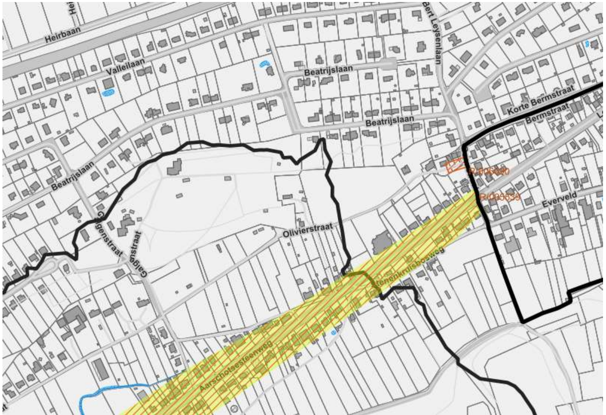
Figuur 156: Geplande RWA-riolering (blauwe pijlen) en buffering (paars) in Fluviusproject R/005539 in deelzone Heidelaakbeek (geel gemarkeerd)
