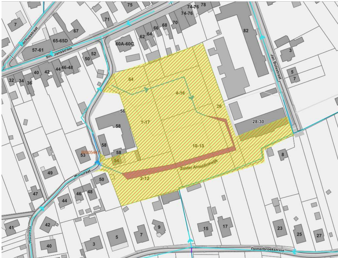
Figuur 187: Geplande RWA-riolering (blauwe pijlen), grachten (blauw gestreept) en infiltratieleidingen (blauw gestipt) in Fluviusproject R/005447 (geel gemarkeerd).
