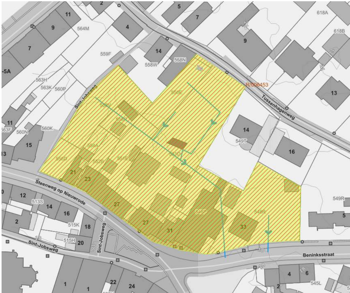
Figuur 106: Geplande RWA-riolering (blauwe pijlen) en buffering (paars) in Fluviusproject R/006453 (geel gemarkeerd)
