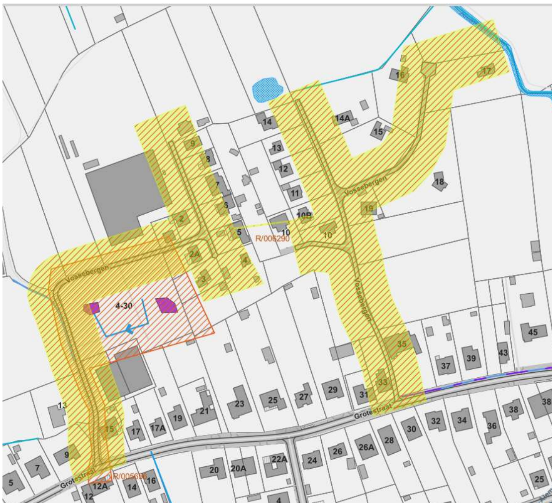
Figuur 184: Geplande RWA-riolering (blauwe pijlen), grachten (blauw gestreept) en infiltratieleidingen (blauw gestipt) in Fluviusproject R/006290 (geel gemarkeerd).
