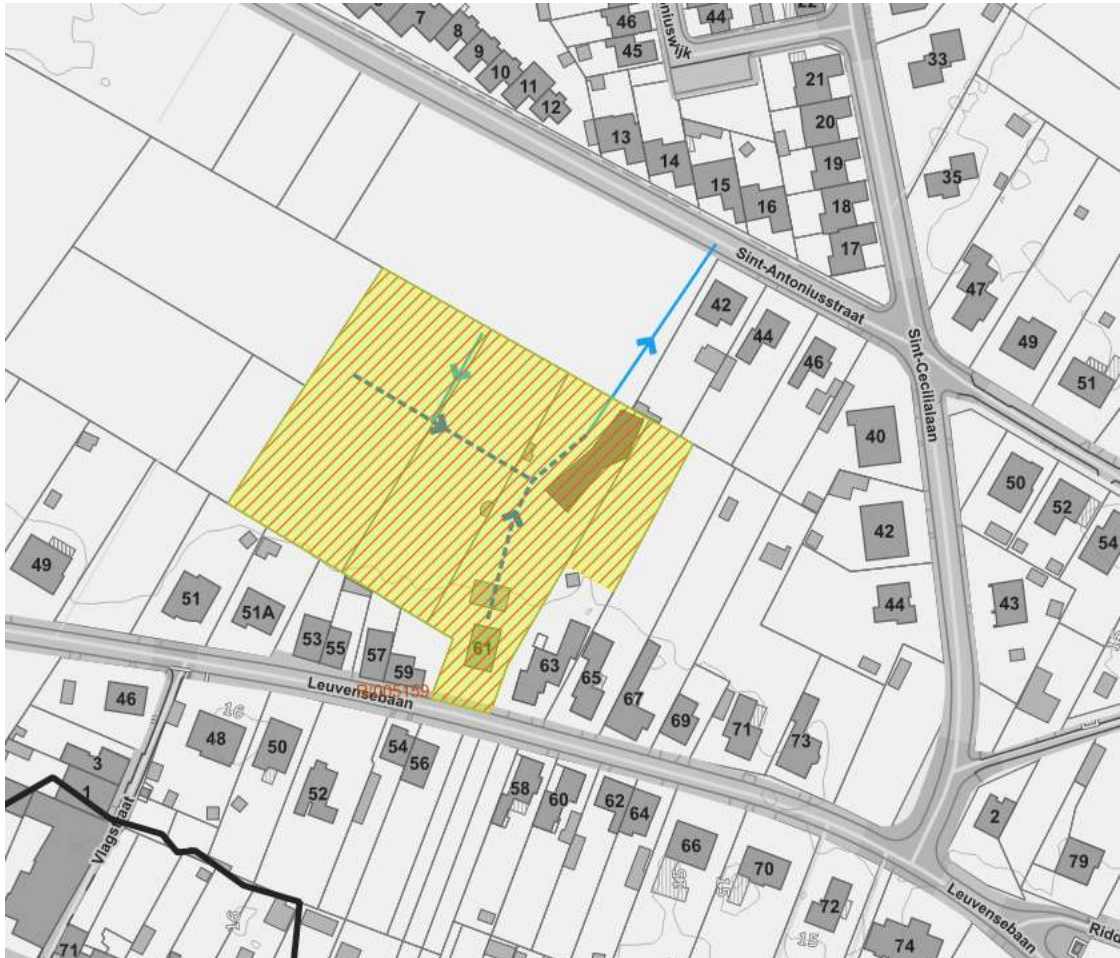
Figuur 113: Geplande RWA-riolering (blauwe pijlen) en buffering (paars) in Fluviusproject R/005159 (geel gemarkeerd)
