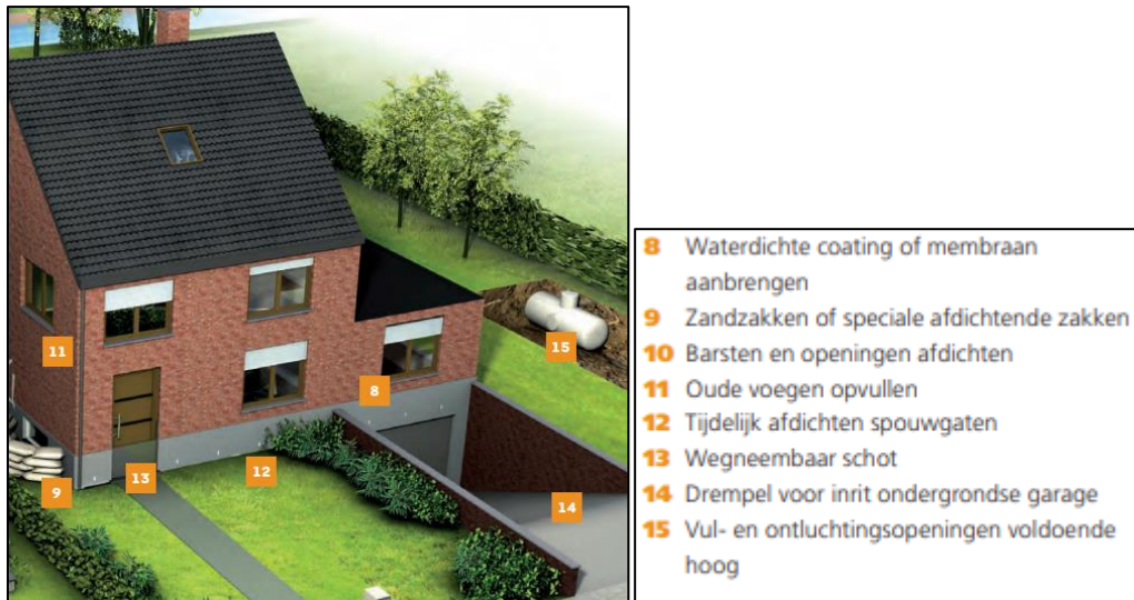
Figuur 86: Overstromingsgevoelig bouwen bij een bestaande woning (Integraal Waterbeleid, 2011)
