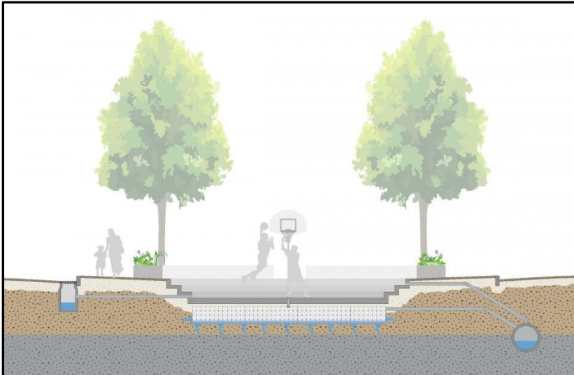
Figuur 80: Speelplein met bergingsfunctie, waarbij ondergronds geïnfilteerd kan worden (Amsterdam rainproof, sd)
