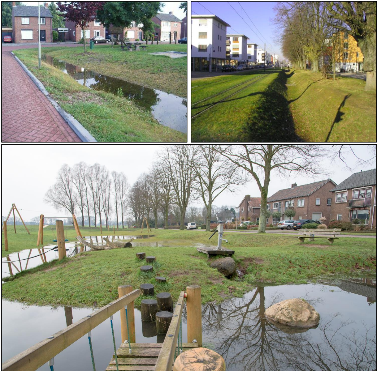
Figuur 76: linksboven: straat watert af naar wadi (Devree, 2021), rechtsboven: infiltratiegracht (Gemeente voor de toekomst, 2021), onder: multifunctionele inrichting met wadi en speelzone (ClimateScan, 2017)
